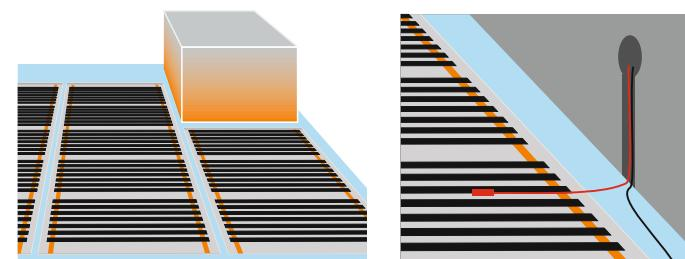
**ВНИМАНИЕ!** Подключение пленочного обогревателя к электрической сети осуществляется параллельно! Все полосы присоединяются к электрическому устройству (терморегулятору) параллельно!
